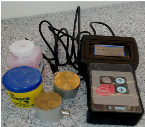
Ultrasonic concrete tester. ۲۴۰-۱۲۰v ac. ۶۰/۵۰hz. ۱ph
