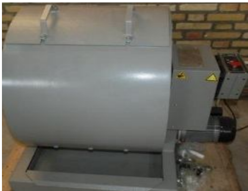
Los angeles abrasion. Mashin mets astm and European standard ۲۴۰-۲۲۰۷ ۵۰hz . ۱ph -set of abrasive charges
