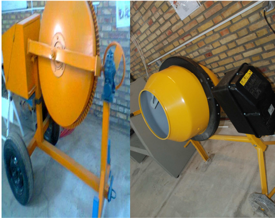
Concrete mixer ۳۰۰-۱۱۵litr mixing capacity
